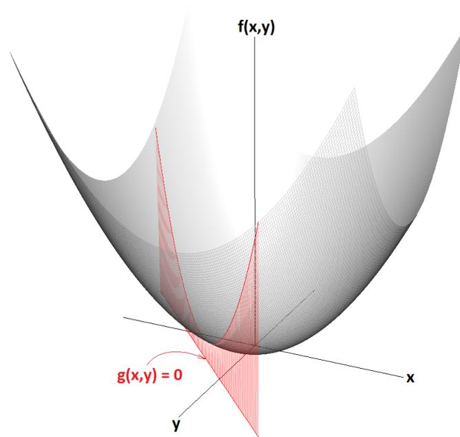
Figure 7: Représentation de  $f(x, y) = x^2 + y^2$  et de la contrainte  $g(x, y) = y - x - \frac{1}{2} = 0$
