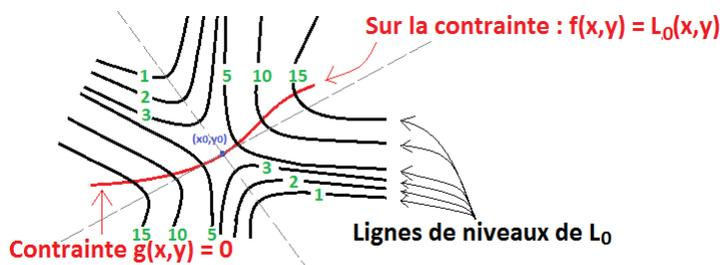
Figure 13: Représentation de  $\mathcal{L}_0$  dans le cas où  $(x_0, y_0)$  point selle de  $\mathcal{L}_0$  et pourtant  $(x_0, y_0)$  minimum local de  $f$  sur la contrainte
